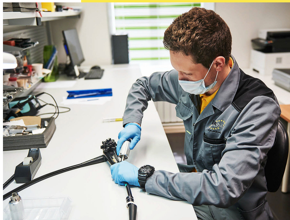
Сервисный инженер проводит сборку гибкого эндоскопа
